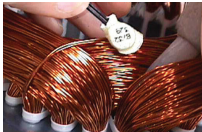
Figura 7.6 - Instalación del protector térmico bimetálico.
